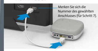
Für Kunden mit UHD-fähigem TV-Gerät: Benutzen Sie nur einen HDMI-Anschluss, der UHD (HDMI2.0 / HDCP2.2) unterstützt. Klären Sie dies für Ihr Fernsehgerät ab. Hilfe finden Sie unter www.swisscom.com/uhd-support
