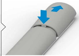
Zum Öffnen des Batteriefaches legen Sie den Daumen auf den Spalt, und schieben Sie mit leichtem Druck den Deckel
