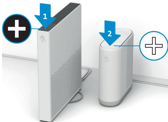
**Vorgehen:** Durch das Drücken der beiden +Tasten (Internet-Box und WLAN-Box 3) innert 2 Minuten werden die beiden Geräte automatisch gepairt.
